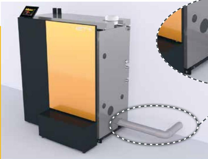
**Raumluftunabhängiger Betrieb.** Die ETA PelletsUnit kann den für die Verbrennung benötigten Sauerstoff von draußen statt aus der Umgebungsluft im Innenraum entnehmen. Der Kessel kann daher auch innerhalb der beheizten Gebäudehülle stehen, ohne dass im tiefsten Winter permanent ein Fenster geöffnet sein muss.
