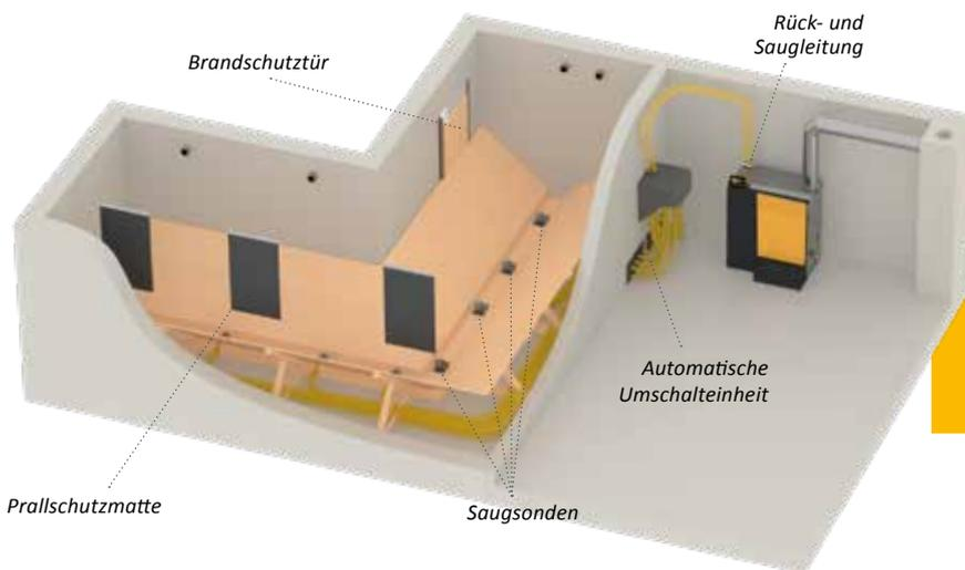
Mit den Saugsonden können nahezu alle Räume für ein Pelletslager genutzt werden, auch wenn der Lagerraum verwinkelt ist. Bei größeren Lagerräumen sind auch 8 Sonden möglich.
