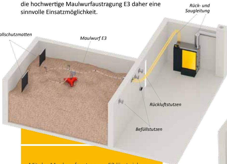
Mit der Maulwurfaustragung E3 lässt sich der Lagerraum fast vollständig entleeren und die schräge Holzkonstruktion entfällt.
