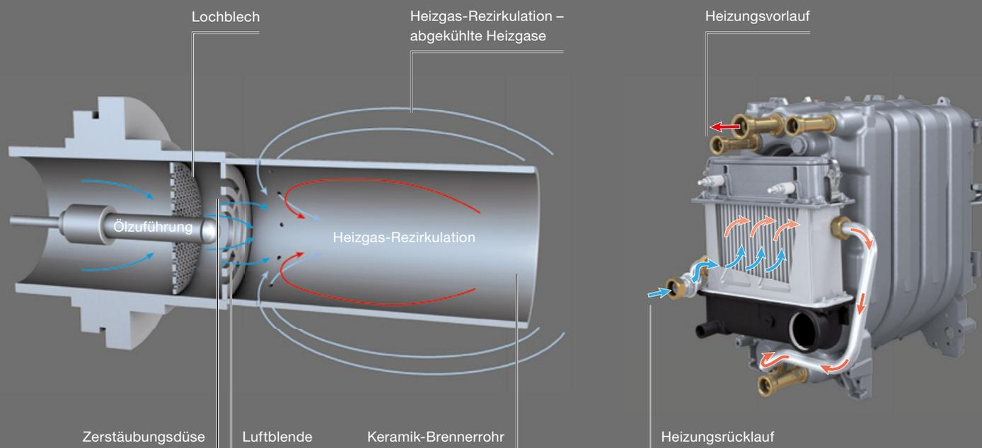
Mit raffinierter Technik garantiert der Blaubrenner Logatop BE<sup>1</sup> eine besonders effiziente und praktisch rußfreie Verbrennung. Ein Unterdruck an der Öl-Austrittsdüse saugt die Heizgase zurück. So verdampfen die Öltröpfchen, bevor sie verbrennen.
