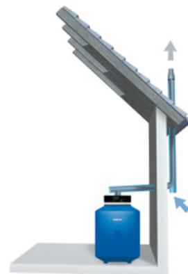
Raumluftunabhängige Aufstellvariante mit Rohr-in-Rohr-Kunststoff-Abgassystem entlang der Außenfassade.
