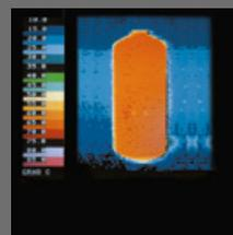
Der Glattröhrwärmetauscher reicht bis zum Speicherboden und erwärmt gleichmäßig den gesamten Speicherinhalt. Das verhindert Kaltzonen und schützt vor Verkeimung.
